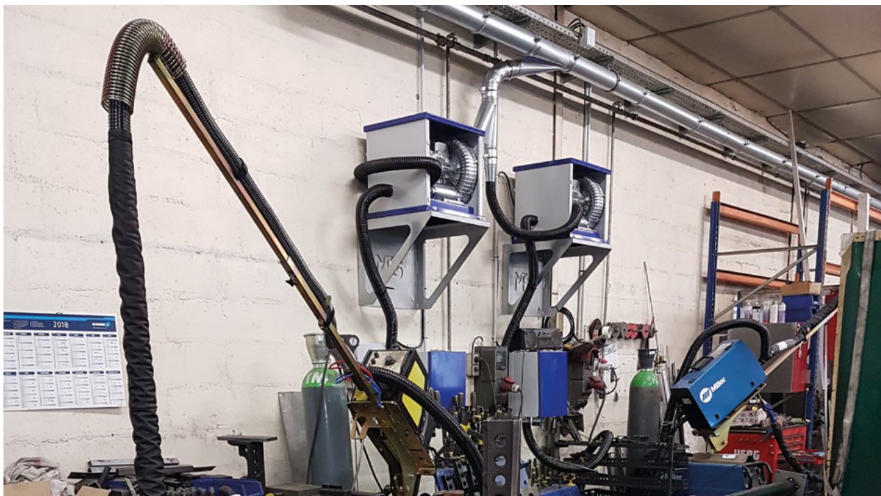
Exemple d'implantation groupe AAT avec kit de déport KDAAT
