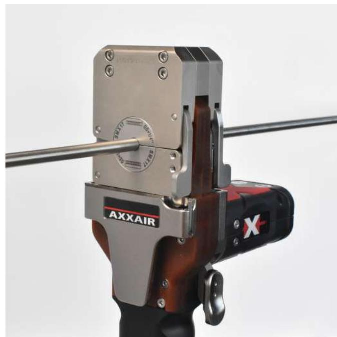
3- **Le cycle est lancé** pour effectuer une soudure automatique. Cette tête est utilisée en combinaison de notre poste à souder de la gamme SAXX et compatible avec toutes les fonctionnalités : gestion de 2 lignes de gaz, surveillance de la soudure par alarme, auto-calcul des paramètres de soudage, prise en main à distance.
