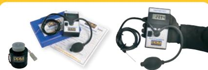
PPM propose également une gamme complète de systèmes de surveillance de la purge des soudures pour mesurer avec précision le niveau d'oxygène à l'intérieur de la chambre de soudage afin d'obtenir une soudure de haute qualité et pureté.
