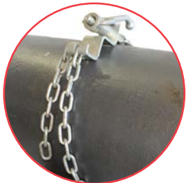
Le dispositif de maintien à chaîne 3506 bloque le pipe à la servante
