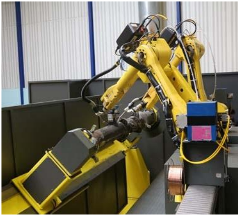
Fabrication de machines agricoles Cellule de soudage avec 3 robots
