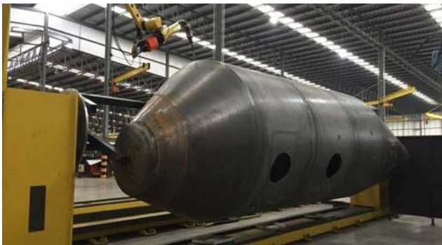
Fabrication de remorques Colonne de soudage et positionneurs
