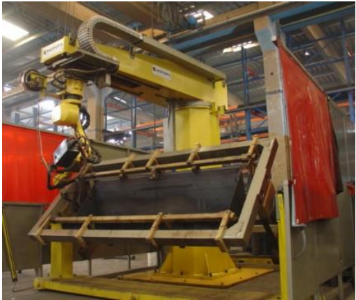
Fabrication de structures agricoles Colonne tournante avec positionneurs
