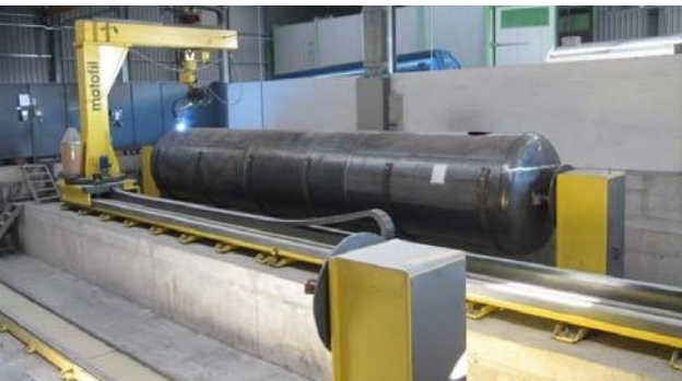
Fabrication de réservoirs Colonne de soudage et positionneurs
