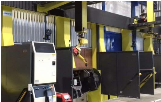
Soudage de pièces agricoles avec différentes géométries Cellule de soudage avec 6 postes de travail
