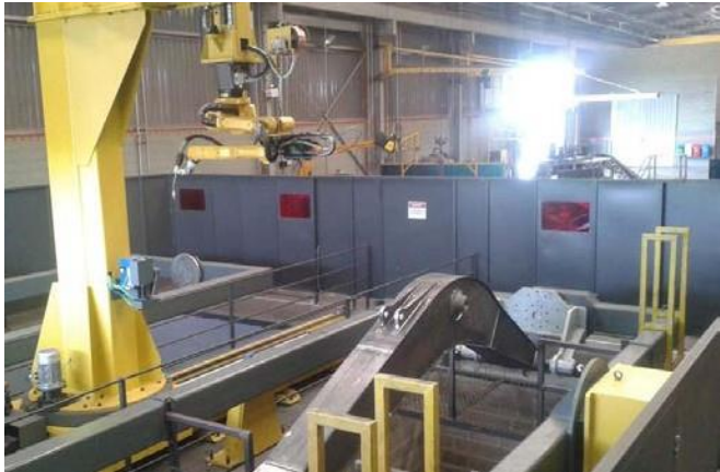
Production de composants agricoles Colonne de soudage avec positionneurs spéciaux
