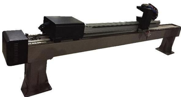
En position parking, l'empreinte au sol de la machine Axxia (hors CNC) est réduite à 2,5 m<sup>2</sup>
