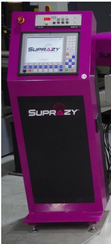
Indépendant du portique, le pupitre de commande contient les organes d'alimentation, le coffret de gestion d'arc, les modules d'asservissement des axes, et la commande numérique.
