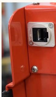
Les générateurs de soudage de la gamme SAXX sont désormais tous équipés en standard d'un port Ethernet à l'arrière du générateur. Permettant ainsi une **connexion rapide à un réseau informatique** existant avec un câblage RJ45 Cat 5 ou supérieur S/STP.
