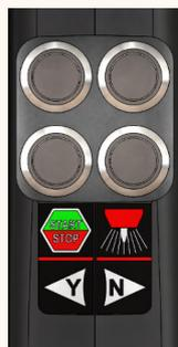
**4 boutons de télécommande en inox :** Start/stop, déclenchement de la purge gaz, rotation du rotor dans un sens et rotation dans l'autre sens. Quelle que soit la position de départ lors de la soudure, le rotor revient automatiquement dans la position ouverte du rotor afin de faciliter la sortie des pièces soudées.
