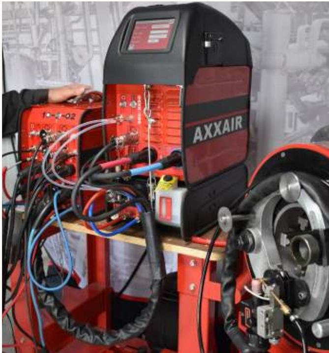
La carte d'axe, qui permet de piloter les moteurs utilisés sur les têtes, a été particulièrement étudiée pour pouvoir piloter différents moteurs et asservissements:
