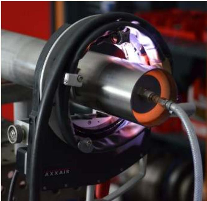
Ce type de machine peut être utilisé pour souder des tubes en acier au carbone.
