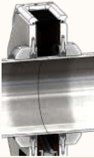
**Mors larges en aluminium :** stabilité optimale de la machine pour le soudage d'accessoires.
