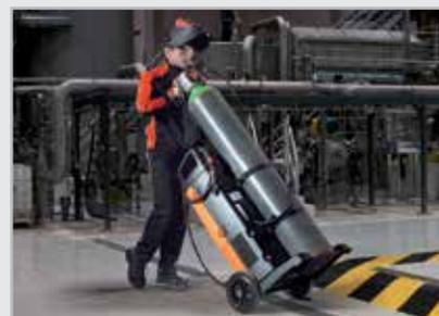
*Le châssis de type GasMate facilite le rassemblement, le stockage et le déplacement des bouteilles de gaz. Les bouteilles de gaz sont chargées au niveau du sol et stabilisées avec un solide système de sangles en tissu.*
