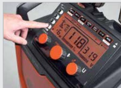
*Les modèles Kempact Adaptive (A) comportent diverses fonctions spéciales : réglage de puissance en fonction de l'épaisseur de la plaque, sélection du métal d'apport et mémorisation des paramètres.*
