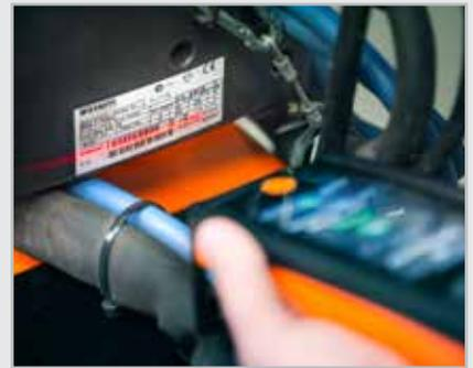
*ArcValidator RC enregistre toutes les données individuelles du processus de validation pour les transférer ultérieurement au logiciel sur PC.*
