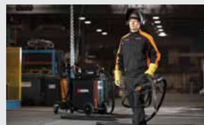
L'utilisation d'un dévidoir auxiliaire léger constitue une option plus ergonomique que le transport de grands dévidoirs lourds ou le soudage avec des torches push/pull lourdes qui augmentent les tensions sur le poignet du soudeur.
