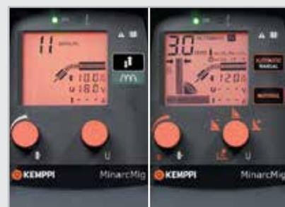
Les modèles MinarcMig Evo 170 et 200 sont fournis avec leurs panneaux de réglage LCD. Le MinarcMig Evo 200 permet aussi de sélectionner le type de matériel, l'épaisseur de la tôle et la forme de la soudure.
