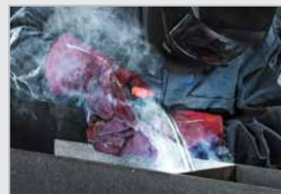
Le procédé MIG/MAG du X3 MIG Welder a été soigneusement conçu pour garantir une stabilité d'arc remarquable, ce qui permet de gérer et limiter facilement la production de projections, notamment lors de l'utilisation d'un gaz de protection CO<sub>2</sub> peu coûteux. Lorsque le besoin de meulage post-soudage est réduit, les soudeurs peuvent se concentrer sur leur productivité.
