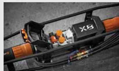
Le X8 SuperSnake est équipé d'une version à deux galets du puissant dévidoir à verrouillage du X8 Wire Feeder. Les consommables sont interchangeables et associés à un code couleur pour vous garantir de toujours utiliser la combinaison appropriée.
