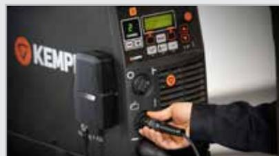
*Le module numérique de connectivité (DCM) est conçu de manière à être compatible avec la famille de produits du nouveau MasterTig et Kemppi FastMig, y compris X5 FastMig, ainsi qu'avec tout autre modèle ou marque d'équipement de soudage grâce aux adaptateurs WeldEye. X8 MIG Welder offre une connectivité native à WeldEye. Il n'est donc pas nécessaire d'adopter un dispositif supplémentaire.*
