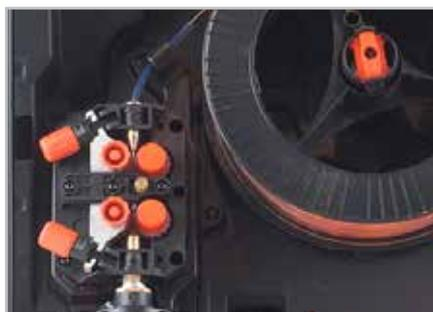
Les modèles Kempact 253/323 comprennent le système de dévidage à 4 galets DuraTorque.
