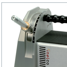
Affûtage de l'électrode avec l'angle désiré.
