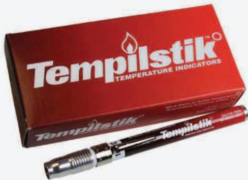
Les crayons TEMPILSTIK sont fabriqués à partir de matières dont le point de fusion est calibré avec une tolérance garantie de  $\pm 1\%$ . La gamme comprend 177 crayons dont les températures de fusion s'échelonnent de  $38^{\circ}\text{C}$  ( $100^{\circ}\text{F}$ ) à  $1371^{\circ}\text{C}$  ( $2500^{\circ}\text{F}$ ).
