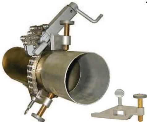
Le clamp à chaîne Mini-Fit est un outil d'alignement pour les tubes de Ø ¾" à 8" avec un schedule 40 maxi (acier ou inox).
