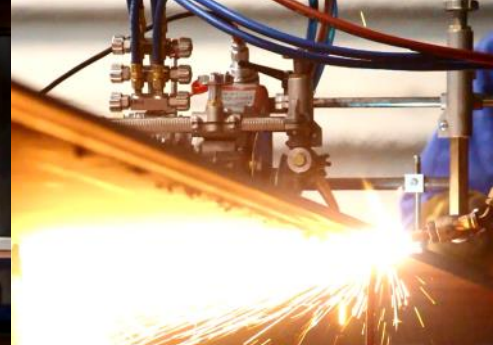
Chanfreinage (1:4 rotation d'angle) à l'aide d'un seul chalumeau
