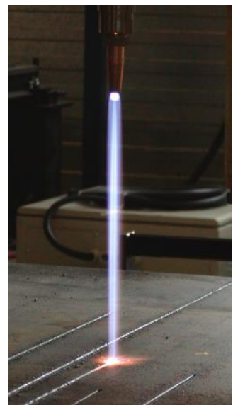
Fort courant d'oxygène de coupe provenant d'une buse divergente : Photo prise du test de performance en interne chez Koike. Pointe de buse à 275 mm au-dessus de la plaque, buse 106-D7#0.
