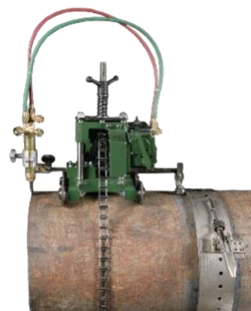
Le rail de guidage en option permet une précision de coupe élevée, en particulier appropriée pour les gros tuyaux. Chaque rail de guidage est doté de maillons de chaîne supplémentaires prévus pour chaque diamètre maximal du tuyau.
