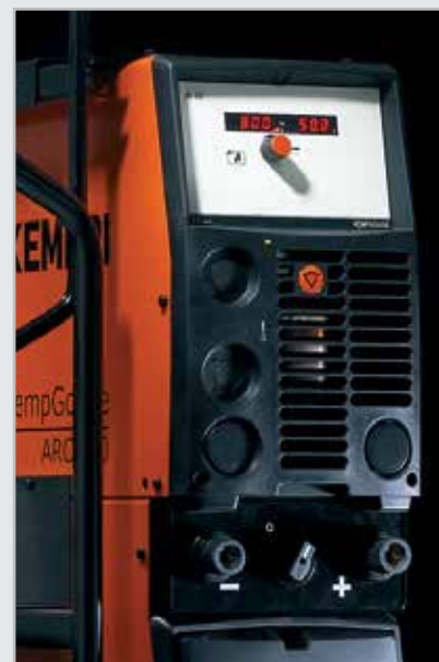
Poste à souder industriel mobile pour gougeage à l'arc de carbone, adapté aux tâches d'élimination et de découpe de métaux de plusieurs types.
